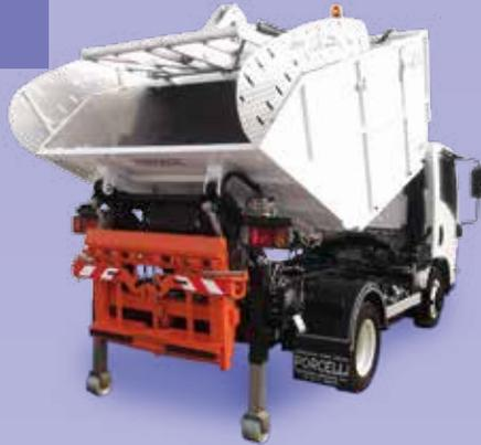
Telo di copertura a movimentazione idraulica
